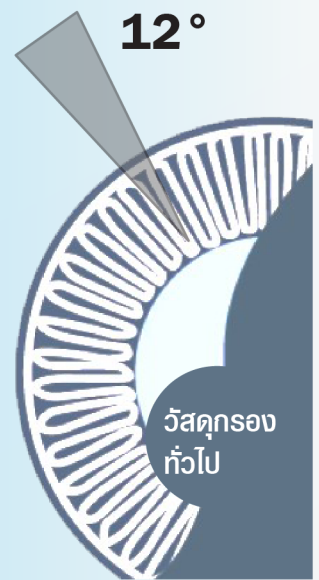
รูปแบบจีบกรองทั่วไป ทำมุมประมาณ 12 องศา
